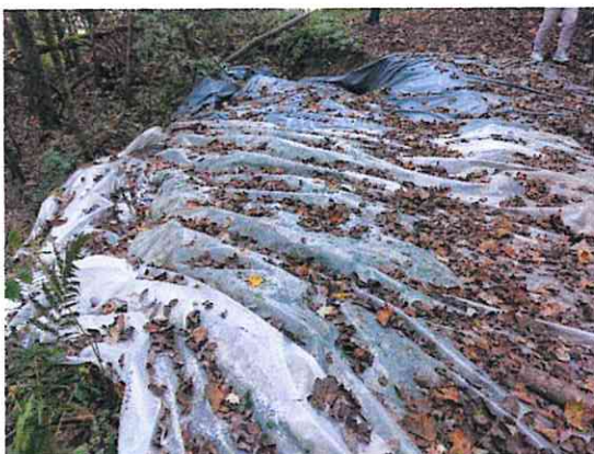
Fotografija 5: Območje razpoke pod gozdno vlako (stopnica globine 50 -100 cm) prekrita s folijo (12.10.2023)
